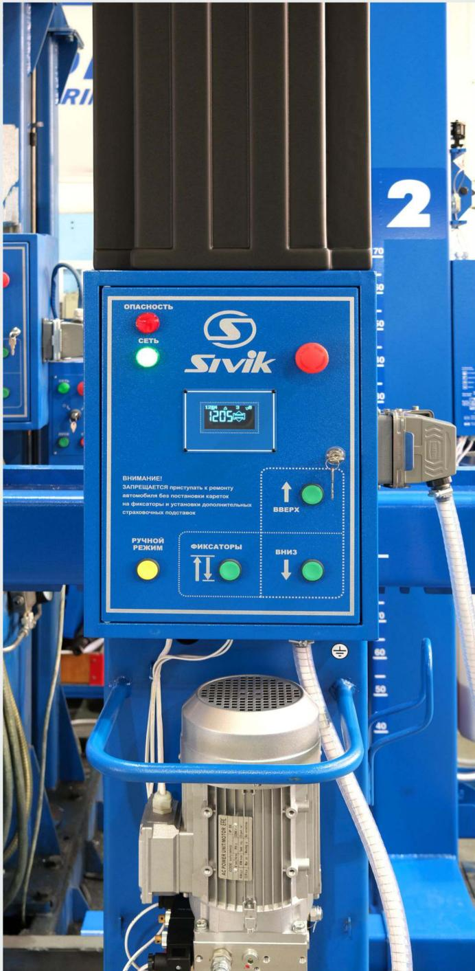
**Электрооборудование подъемника** позволяет управлять всеми колоннами с общего пульта или каждой колонной по отдельности со своего пульта
