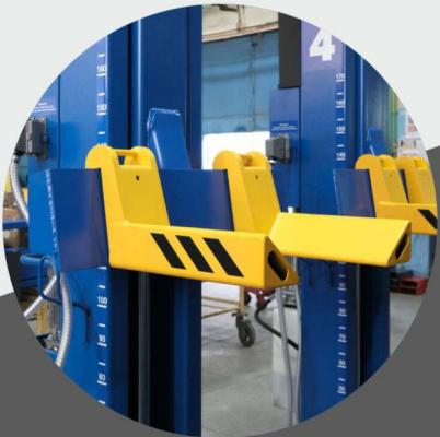
Подхват автомобиля производится за колеса
